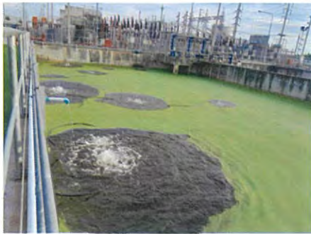
ภาพที่ 2-19 ระบบเติมอากาศ
